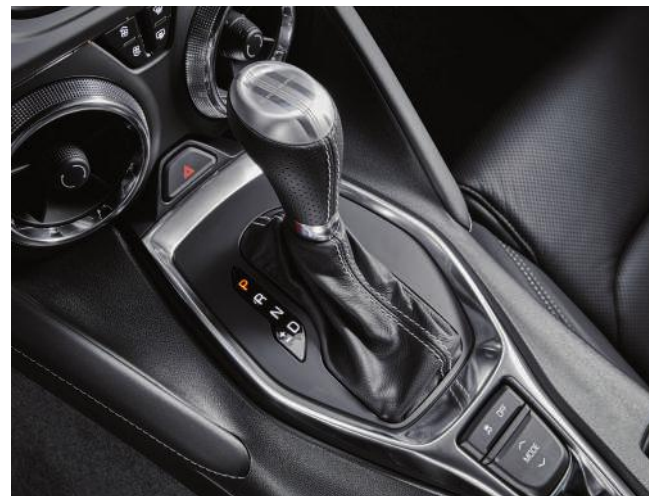
하이드라매틱 10단 자동변속기 드라이브 모드 셀렉터 / 전자식 주차 브레이크(EPB)
